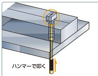
金型のメンテ時、パンチ部品ダイス部品を取りはずす時、または組み込む時にハンマーと共に使用します。
