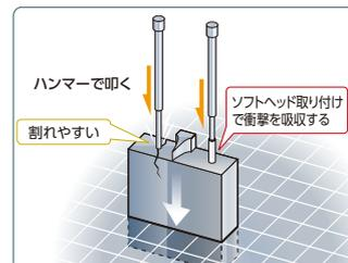
割れやすい超硬をセットする時はソフトヘッドを取り付けて使用することで衝撃を最小限に抑えます。
