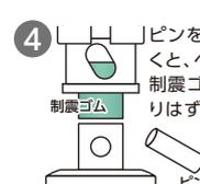
4 ピンを押し抜くと、ヘッドと制震ゴムが取りはずせます。
