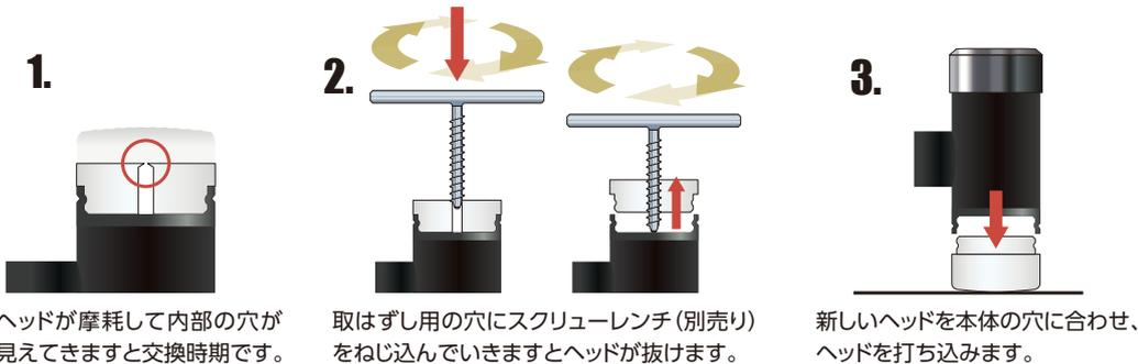
1. ヘッドが摩耗して内部の穴が見えてきますと交換時期です。
