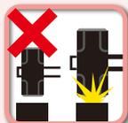
強打撃はせず、**1サイズ大きな**ハンマーを使用する。
