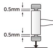
ヘッドを取り付けると、替銅ヘッドと本体の間に0.5mm 強のスキ間があります。金敷きにハンマーを数回強打するとスキ間はなくなり密着します。スキ間のあいたまま使用すると替ヘッドがガタつく原因になります。
