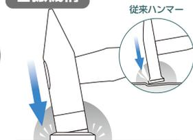
ヘッドが首振機構になっていますので打撃のブレを吸収し、打撃面の角によるヘコミを防ぎます。
