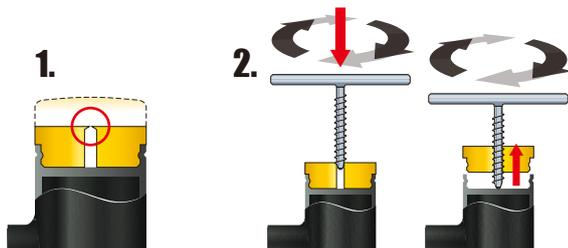
1. ヘッドが摩耗して内部の穴が見えてきますと交換時期です。
