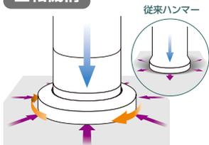
打撃時にヘッドが回転することにより、周辺の金属組織を回転面内に引込み、伸びを吸収します。
