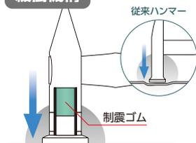
内部の制震ゴムが過度の衝撃を吸収するので、従来ハンマーのように打撃部がヘコまず、打痕が付きません。
